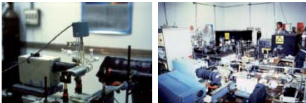
(Izquierda) Montaje experimental detectar fluorescencia de radicales y especies moleculares excitados eléctricamente. (Derecha) el doctor De la Figuera en su Laboratorio de Técnicas Láser (IQFR)
