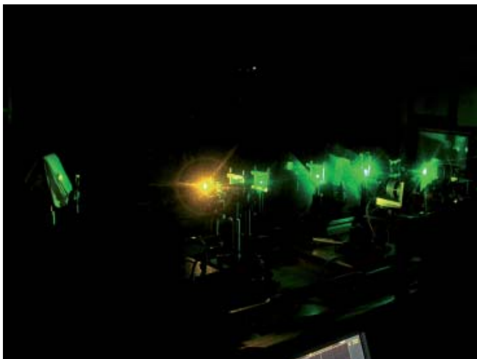
Láser de colorantes con bombeo transversal (IQFR)
