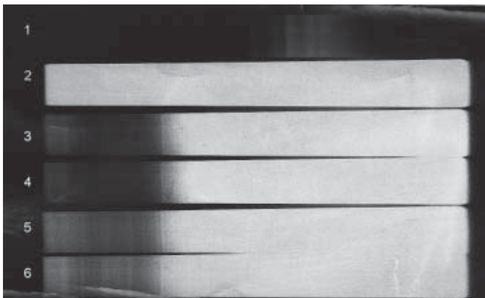
Figura 1. Espectros de la emisión de fosforescencia (1) y absorción del estado triplete del ácido benzoico (3-6) en una matriz a 77K, obtenidos mediante fotólisis de destello en 1974 en la sección de Cinetoquímica del Instituto Rocasolano (Acuña et al. , 1975: 22).
