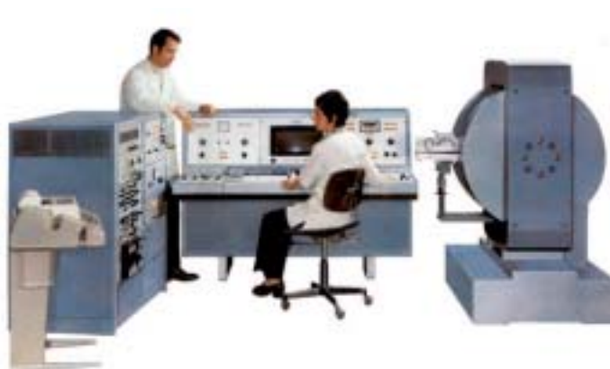
Espectrómetro de RNM de Burker de los años sesenta. A la izquierda montaje fotográfico de la sala de RNM (IQFR)
